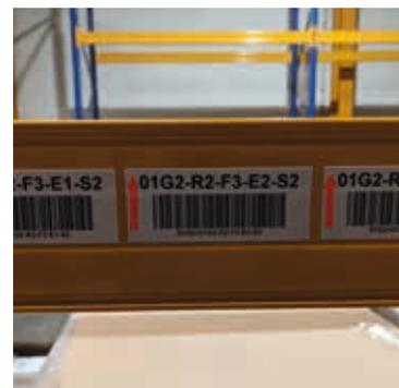
Die Barcodierung der Stellplätze ermöglicht eine genaue Zuordnung der dort gelagerten Bauteile zum Stellplatz.
